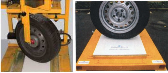
Bild 3: Prüfverfahren für befahrbare Beschichtungen nach /3/ (links) sowie Parking Abrasion Test PAT nach /4/ (rechts)
