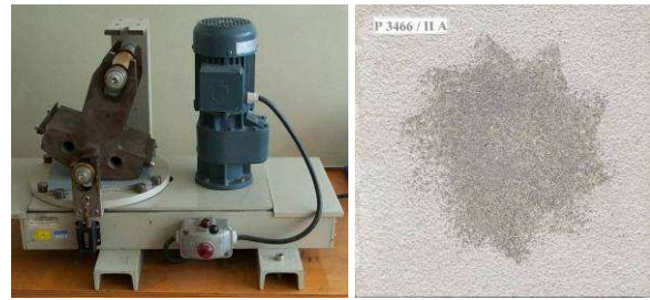
Bild 2: Beispiel der Verschleißprüfung eines OS 11 Systems im Labor. Prüfgerät (links), Faserzementplatte mit OS System nach Versuch (rechts), Bilder: Kiwa Polymer-Institut
