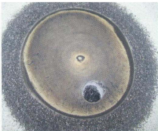
Bild 5: Oberflächenschutzsystem OS 11a vom Ausgangszustand (oben) bis zum Ende des PAT-Tests (unten); Bewertung: Verschleißklasse 6 – Systemausfall nach /4/
